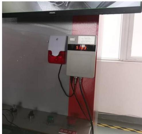
固定式场所辐射探测报警装置
